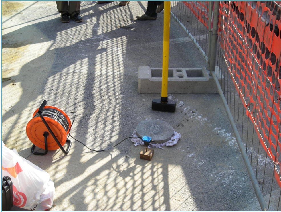
Fig. 7 – Sorgente energizzata, costituita da massa battente su piastra di alluminio. Come starter/trigger è stato utilizzato un geofono verticale Geospace a 14Hz.
